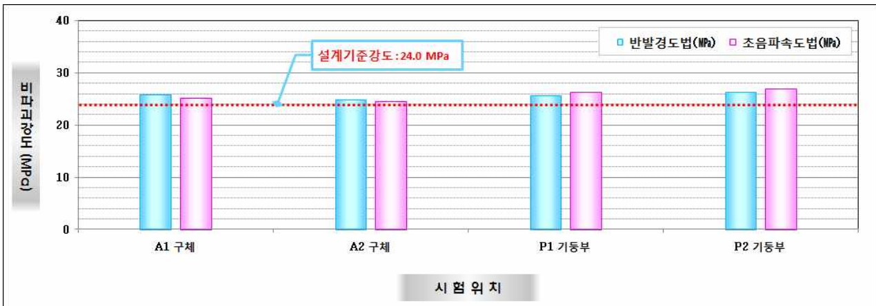
【그림 3.4.12】하부구조(교대, 교각) 평균압축강도 추정결과(대구)
