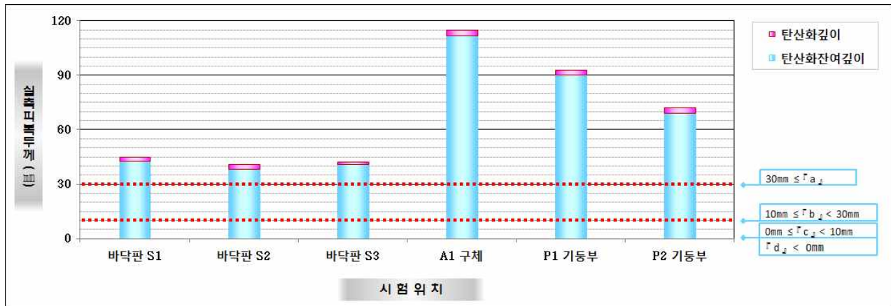
【그림 3.4.17】 탄산화 깊이 측정결과(부산)
