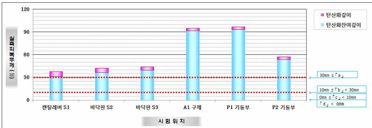
【그림 3.4.13】 탄산화 깊이 측정결과(대구)
