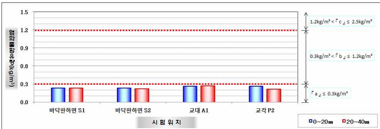
【그림 3.4.14】 염화물시험 측정결과(대구)
